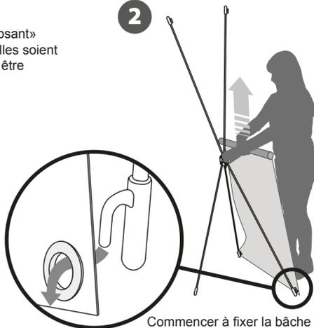
Commencer à fixer la bâche sur le bas de la structure en passant les oeillets dans les crochets.
