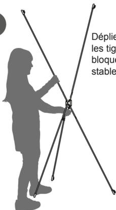
Dépliez la structure en «clipsant» les tiges de façon à ce qu'elles soient bloquées. Le structure doit être stable en position dépliée.
