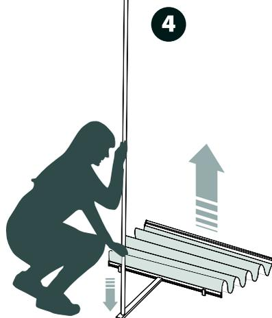
Déployez la tige et faites tourner les sections du tube en vissant pour qu'elle soit ajustée à la bonne taille et assure la tension de la bâche. (Pour le démontage vous dévisserez).
