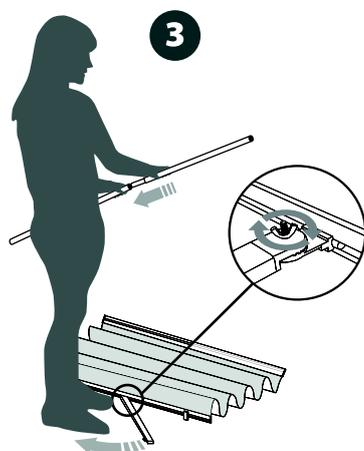
Dépliez le pied et serrez le papillon lorsqu'il est position perpendiculaire à la barre de maintien du bas de la bâche.
