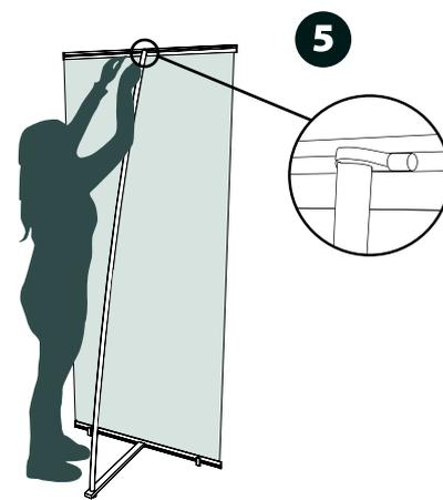
Connectez le haut de la tige avec la pièce que vous avez fixée sur la barre du haut. Pour un beau rendu ajustez si nécessaire la tension de la bâche et jouant sur la longueur de la tige télescopique.
